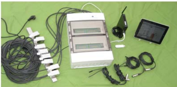
4 Kanal Messkopf mit Internetverbindung & Ipad
